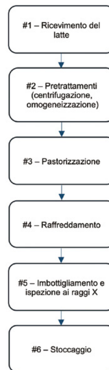
Fig. 3 - Diagramma di flusso del processo di produzione di latte pastorizzato confezionato in bottiglie di vetro.
